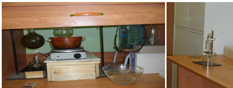
Рис.2. Перегонный (дистилляционный) аппарат с водяным паром и делительная воронка
